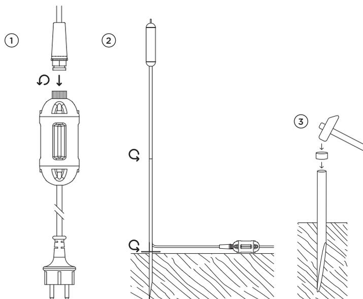
Leuchte luminaire IP65 Driver IP67 Stecker plug IP44
